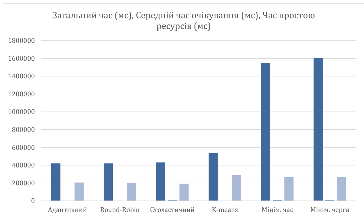
Рис. 3.9. Порівняння загального часу виконання задач при використанні різних методів балансування навантаження grid-системи в режимі недовантаженості
